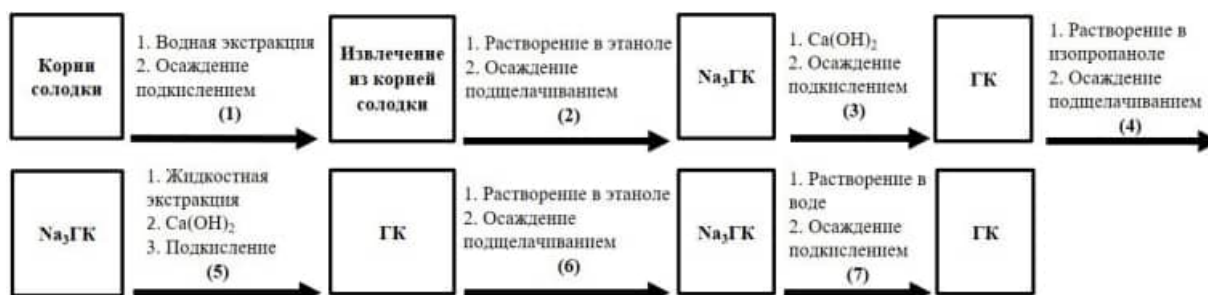
Рис. 1. Технологическая схема разработанного процесса выделения глицирризиновой кислоты
