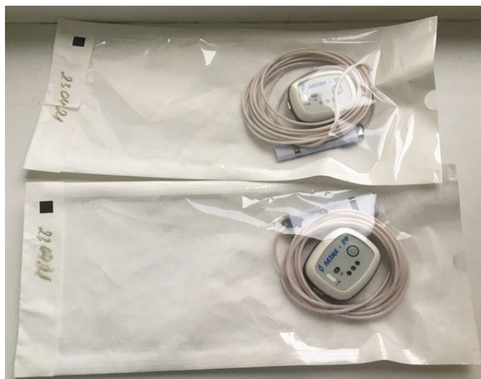
Рис. 1. Анализатор «ЛАЗМА ПФ» в стерильной упаковке после обработки на аппарате STERRAD 100S
