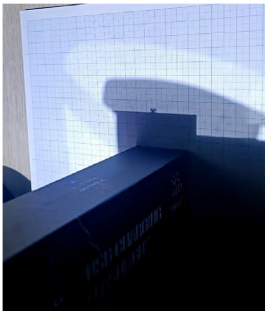
Рис. 1. Тень от брекета для зуба 2.1, полученная с помощью источника направленного света и линзы
