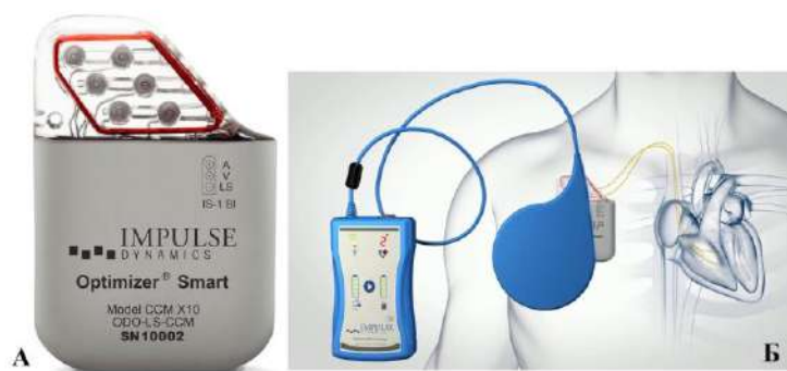
Рис. 3. А – имплантированный пациенту Л.Г.Г. генератор импульсов «Optimizer Smart». Б – схема беспроводной зарядки устройства в течение 1 ч. еженедельно
