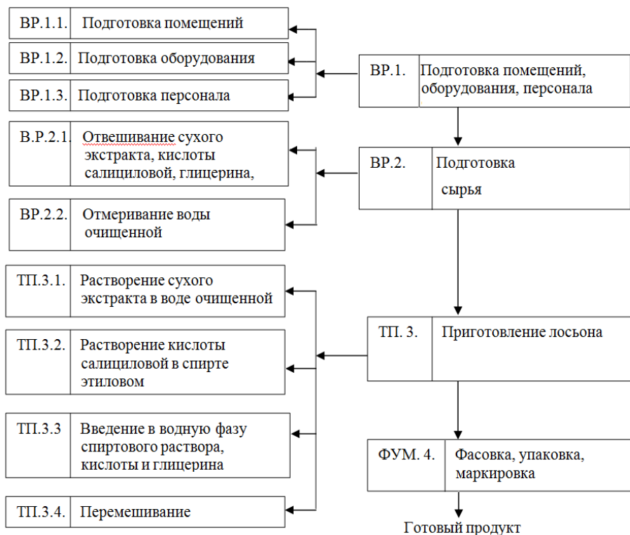
Рис. 2. Технологическая схема получения лосьона с сухим экстрактом скумпии кожевенной
