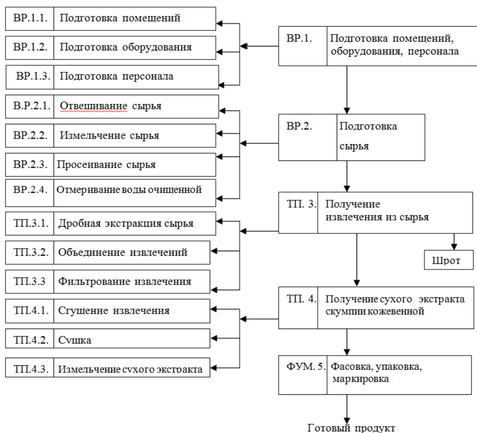
Рис. 1. Технологическая схема получения сухого экстракта скумпии кожевенной
