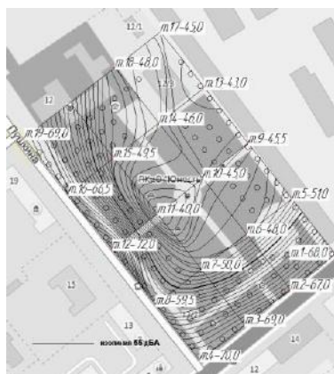
Рис. 2. Карта шума парка «Юность» с применением периметральной защитной полосы шириной 25 м. (В тт. 1-19 указан эквивалентный уровень звука, дБА)
