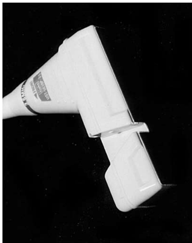
Рис. 3. Общий вид пункционного ультразвукового датчика
