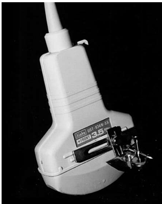
Рис. 2. Общий вид ультразвукового датчика и съемного адаптера
