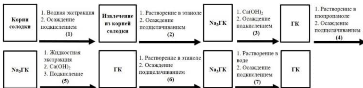
Рис. 1. Технологическая схема разработанного процесса выделения глицирризиновой кислоты
